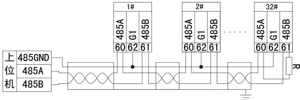
当多个装置组网使用时,最后一个的 RS485 的 A 和 B 端子上应并接一个终端匹配电阻 R,以保证通讯阻抗匹配,终端匹配电阻一般在  $120\Omega$ – $10k\Omega$  之间,布线不同终端匹配电阻可能会不同。上图为使用三芯屏蔽线的示意图,屏蔽层接大地,各个设备的 G1 端子并接。
